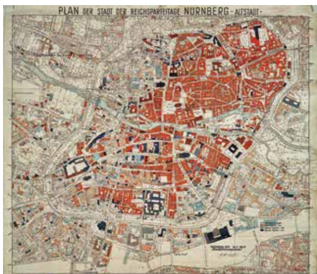
6 Der Schadensplan vom 12. Februar 1945. Rosé stellen sich hier alle Totalschäden und blau alle schweren Schäden vor dem 2. Januar 1945 dar. Rot markiert sind Totalschäden und Schwarz markiert alle schweren Schäden, die die Luftangriffe vom 2. Januar 1945 verursacht haben.
